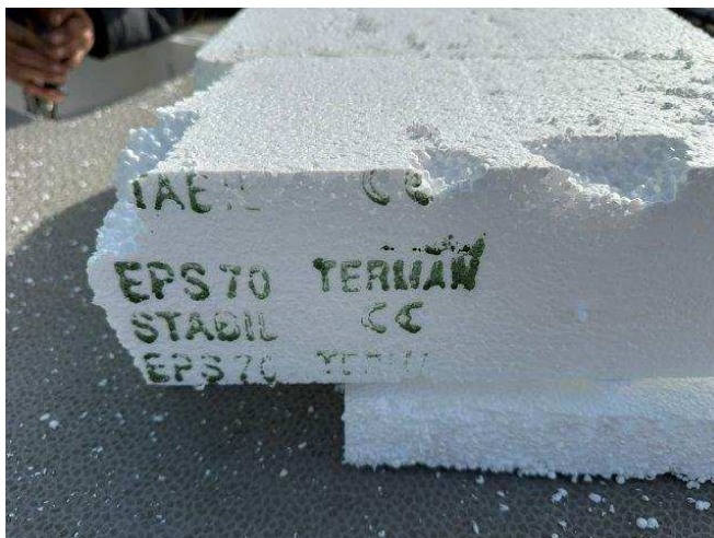
foto /10/ Označení polystyrenu ve skladbě střechy EPS 70 Stabiz
